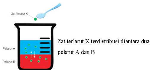
Gambar 18. Ilustrasi ekstraksi, di mana zat terlarut terdistribusi di antara dua pelarut
