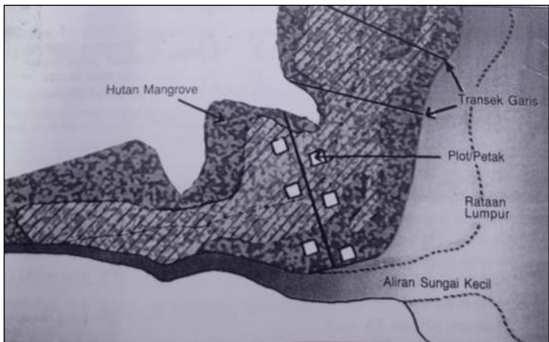
Gambar 8.1 Transek Garis dan Petak Contoh (Plot) Pengukuran Mangrove pada Setiap Zona dari Pinggir Laut ke arah Darat
