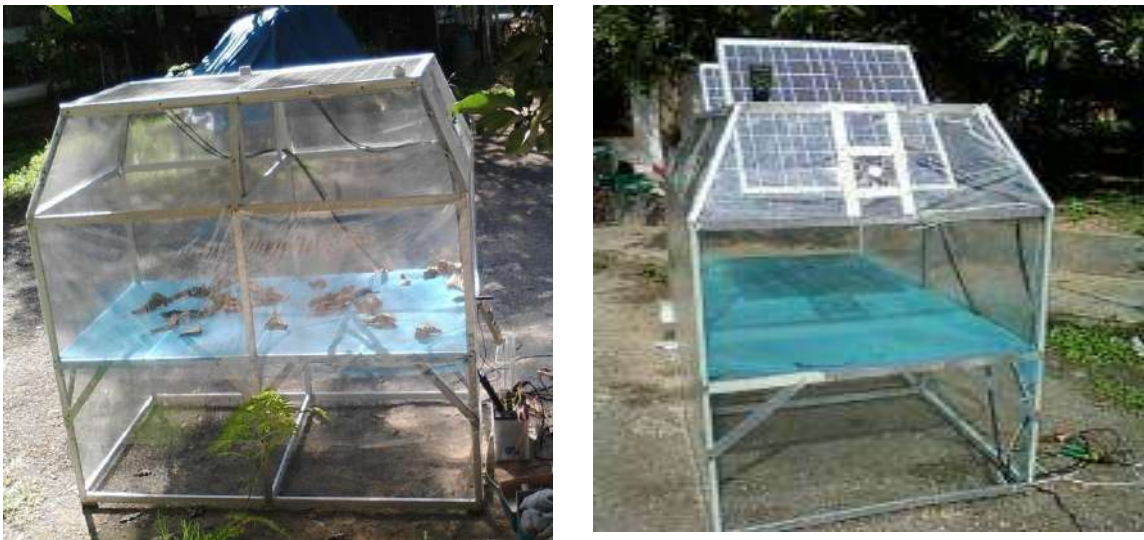
Gambar 5.8 Sistem Greenhouse Dryer dengan (a) force mode ; (b) natural mode
