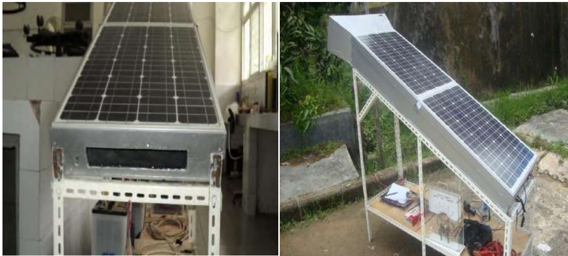
Gambar 4.1 Skema sistem PV/T kolektor udara double pass sebagai penyerap panas
