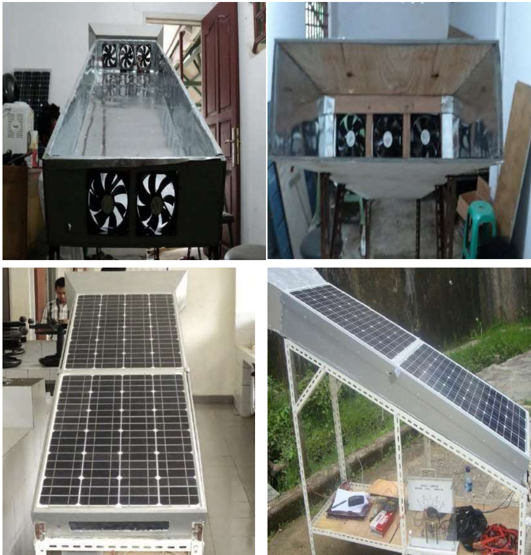
Gambar 5.1 Hasil Modifikasi PV/T terintegrasi kolektor udara ( double pass )
