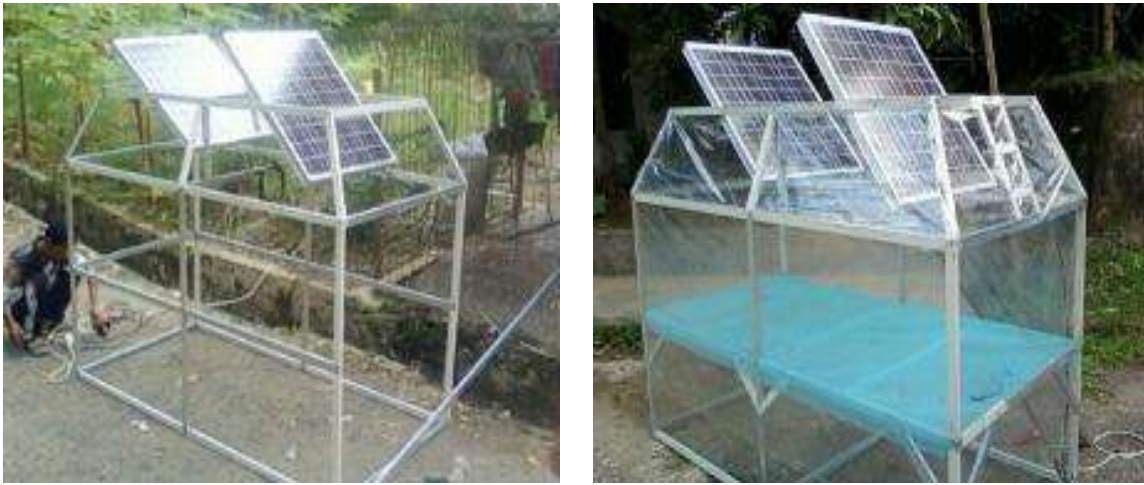
Gambar 5.7 Implementasi Sistem GHD terintegrasi PV/T
