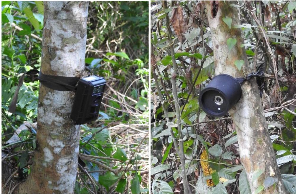
Gambar 7. *Camera trap bushnell HD* dan *webiola flash camera trap*, dua model camera trap yang digunakan di pemantauan PT Kitadin
