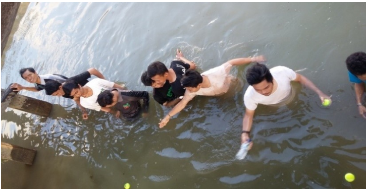
Gambar 10. Pengukuran kecepatan arus sungai dengan menggunakan bahan apung bola tenis dan botol yang diisi air
