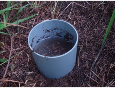
Gambar 2. Pengukuran infiltrasi di Lapangan dengan menggunakan Double Ring Infiltrrometer dan Single Ring Infiltrrometer.
