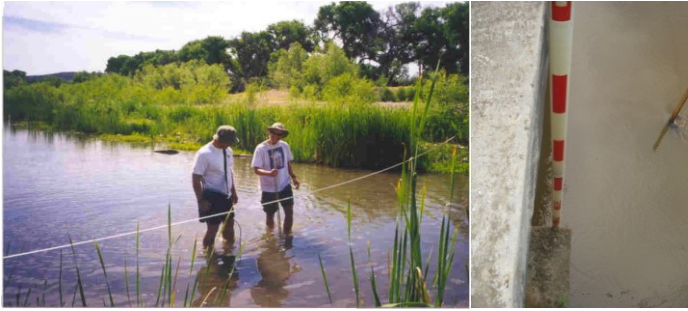
Gambar 9. Pengukuran lebar dan luas penampang basah sungai.
