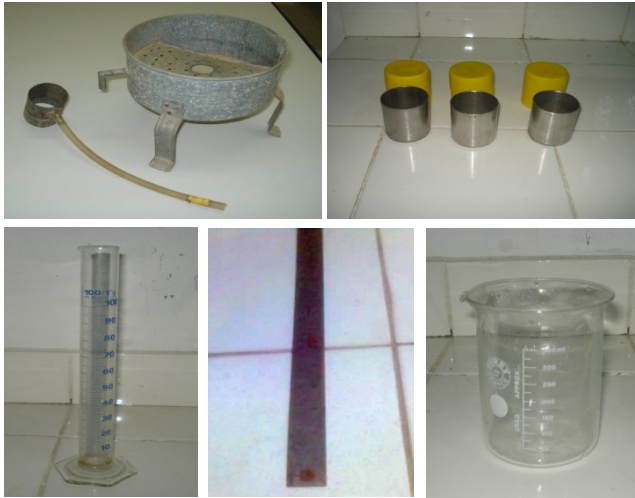
Gambar 4. Beberapa alat yang digunakan pada pengukuran permeabilitas (a) Permeameter, (b) Ring Sampel Tanah, (c) Gelas Ukur, (d) Penggaris, (e) Tabung Erlenmeyer.
