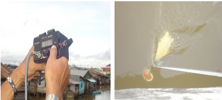
Gambar 11. Pengukuran kecepatan arus sungai dengan menggunakan Current meter
