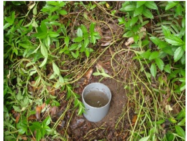
Gambar 2. Pengukuran infiltrasi di Lapangan dengan menggunakan Double Ring Infiltrrometer dan Single Ring Infiltrrometer.
