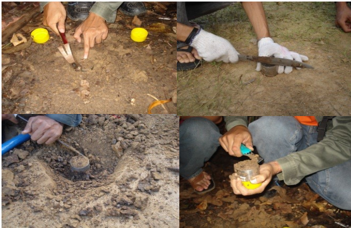
Gambar 5. Pengambilan sampel tanah untuk pengukuran permeabilitas
