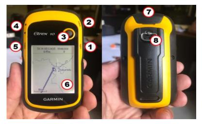
Gambar 27. Penampakan fisik GPS Garmin seri eTrex 10
