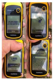
Gambar 36. Tampilan pengukuran area pada Garmin seri eTrex 10
