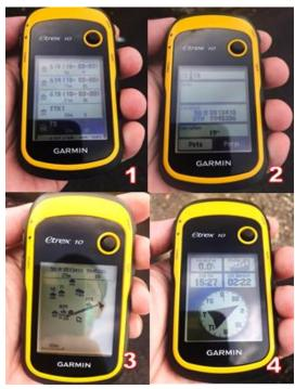
Gambar 37. Tampilan pengukuran area pada Garmin seri eTrex 10
