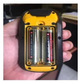
Gambar 28. Penampakan tempat baterai Garmin seri eTrex 10
