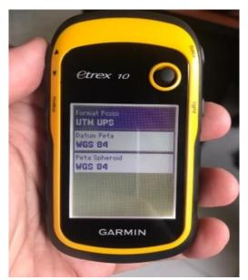
Gambar 32. Tampilan setting datum dan sistem koordinat pada Garmin seri eTrex 10
