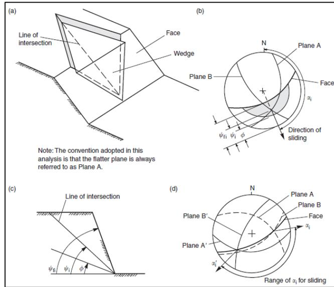
Fig. 4. Illustration Wedge Failure Geometry (Wyllie et al, 2004)
