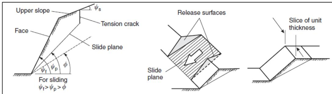
Fig. 3. Illustration Plane Failure Geometry (Wyllie et al, 2004)
