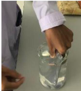
**Gambar 6.1** Proses pengujian kebocoran kemasan
