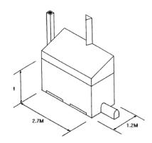
Gambar 2. Kombinasi kayu dan pengering surya,lengkap dengan penutup surya.
