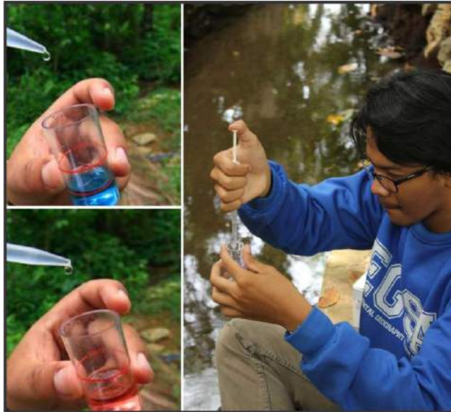
Gambar 4.7. Proses Tirasi dengan Alkalinity Test (Zulqisthi, 2014)
