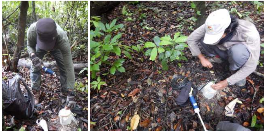
Gambar 4.13. Ilustrasi Penancapan Kitagawa Gas Detector ke dalam Chamber
