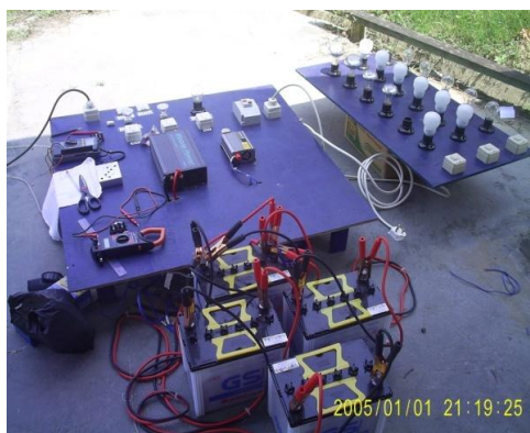
Gambar 4. Prototipe PV-HPS dan komponennya
