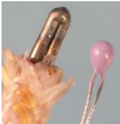
Gambar 2.7: Termokopel dengan kerja berdasarkan perbedaan tegangan.
