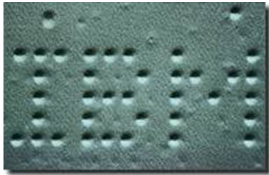
Gambar 1.32: Hasil citra STM: Susunan huruf IBM ( International Business Machines ) dari atom (Sumber: http://education.mrsec.wisc.edu/130.htm ).
