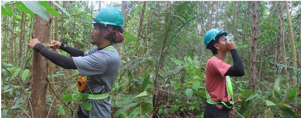
Gambar 3.9. Pengukuran Diameter Pohon dengan Menggunakan Phiband dan Pengukuran Tinggi Pohon dengan Menggunakan Clinometer
