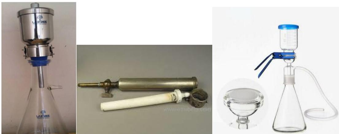
Gambar 6. Beberapa macam filter yang biasa dipakai; kiri-kanan ,Filter Seitz, Filter Chamberland – Pasteur; Filter Gelas
