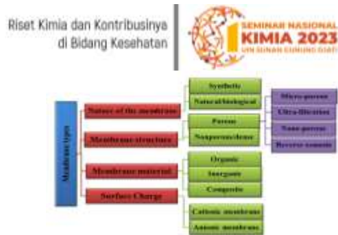
Gambar 2 Diagram skematik yang mewakili berbagai kategori membran yang digunakan dalam industri pengolahan air limbah [14].
