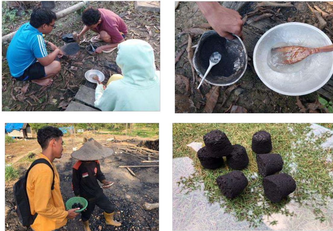
Gambar 1 Proses Pembuatan dan Pencetakan Briket Arang Kayu
