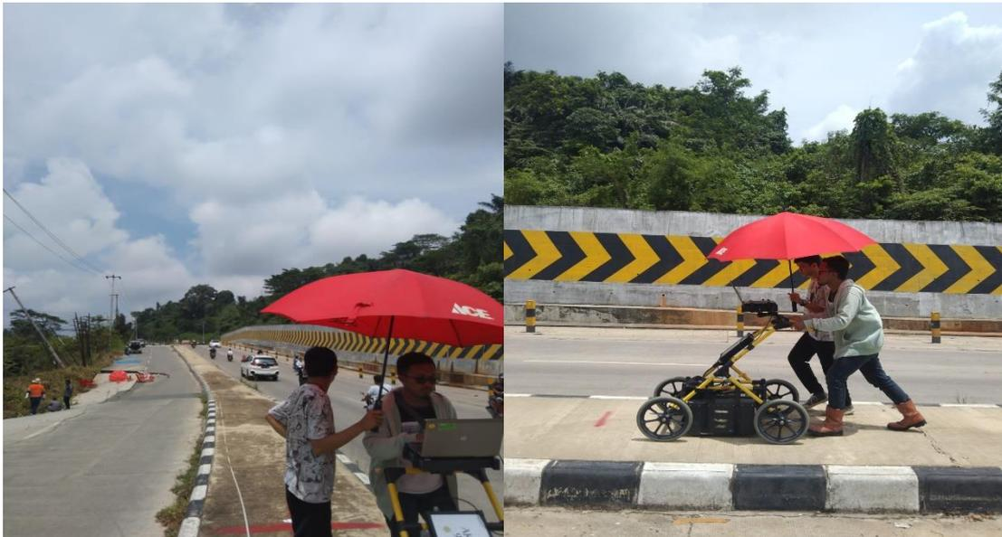
**Gambar 7.** Pengukuran menggunakan metode GPR
