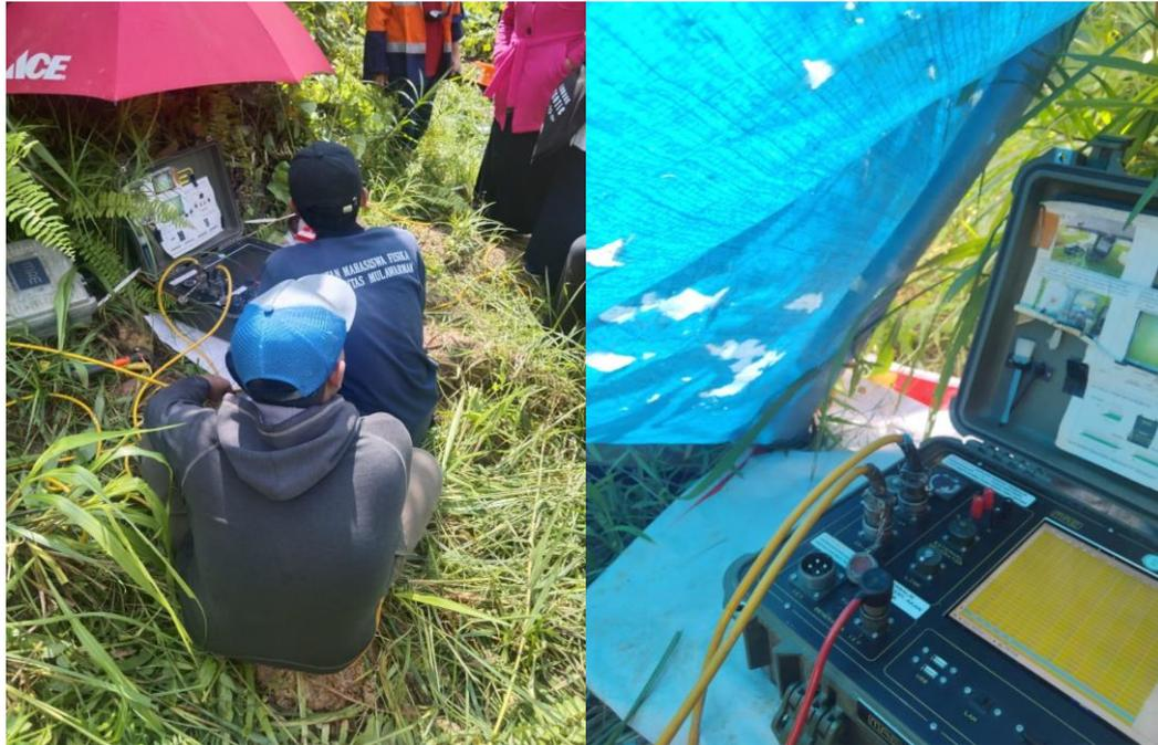
**Gambar 8.** Pengukuran menggunakan metode geolistrik
