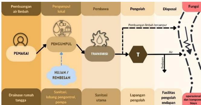
**Gambar 6.2** Sistem Manajemen Air limbah/kotor (Sumber : Grigg, 1996)
