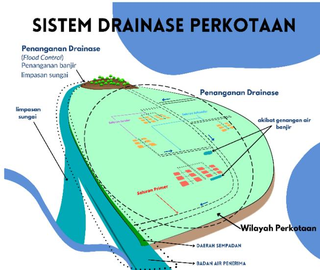
**Gambar 6.5** Sistem Drainase Perkotaan (Sumber : Grigg, 1996 sudah dimodifikasi)
