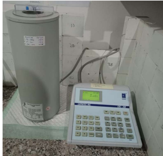
Gambar 1. Dose calibrator dengan Pelindung Ruang Ionisasi dengan Dipper di Bagian Atas, serta Pembacaan Elektronik
