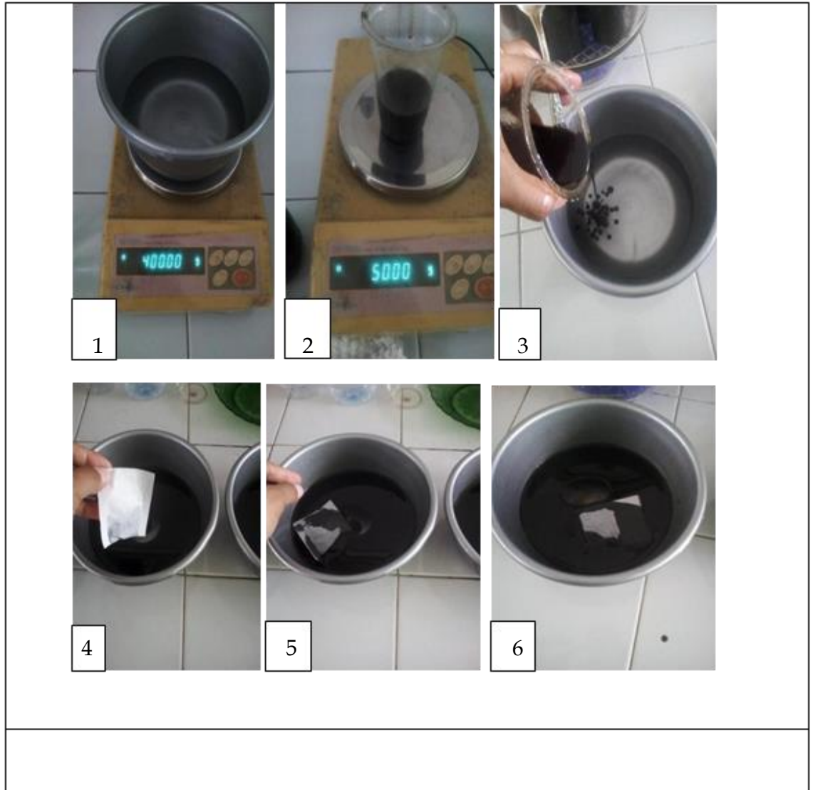
Gambar 6. Urutan Pengujian Adsorpsi Arang Aktif dari Sekam Padi terhadap Tumpahan Pelumas Bekas
