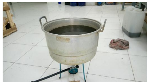
Gambar 4.3. Pemanasan lindi pada proses seeding
