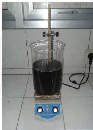
Gambar 4.3. Pemanasan lindi pada proses seeding
