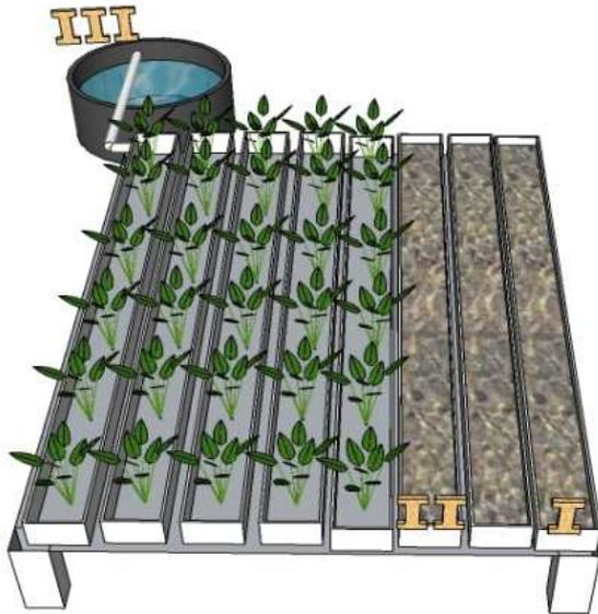
Gambar 2. Biofilter titik sampling pada sistem Akuakultur Multi-trofik terpadu (IMTA). Keterangan : I. Jalur biofilter pertama; II. Jalur biofilter ke-3; III. Penampungan air dari biofilter.
