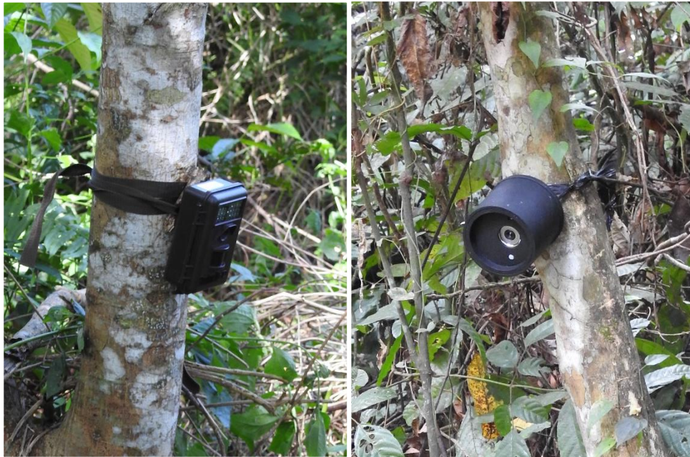
Gambar 8. Camera trap bushnell HD dan webiولا flash camera trap , dua model camera trap yang digunakan di pemantauan PT Kitadin
