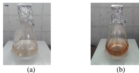
Gambar 2. Larutan (a) \text{AgNO}_3 dan ekstrak daun nipah, serta (b) nanopartikel perak hasil sintesis. Terbentuknya nanopartikel perak ditandai dengan adanya perubahan warna larutan menjadi jingga kecoklatan.
