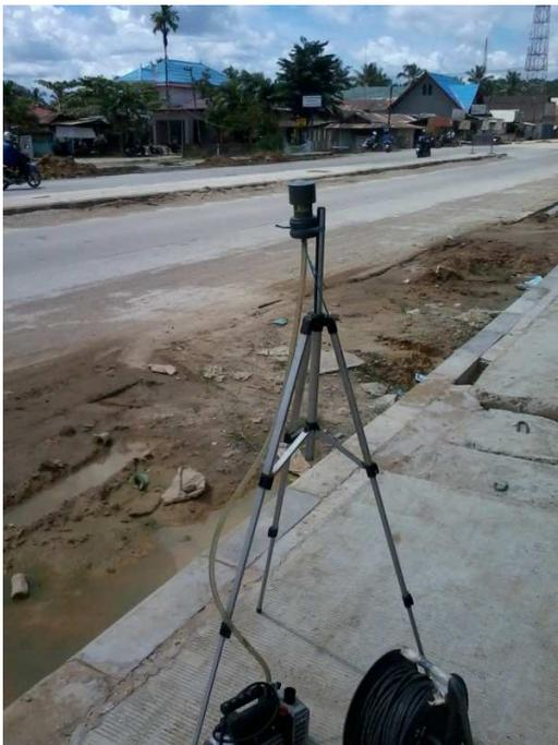
Alat Pengukur PM<sub>10</sub> yang digunakan
