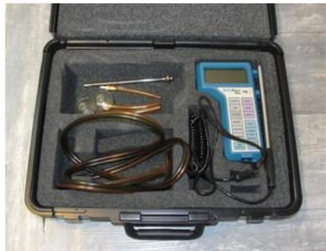
Alat Velocical Plus untuk mengukur kecepatan angin
