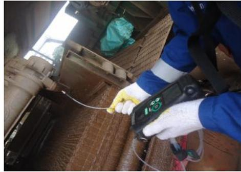
Alat MSA Sirius untuk mengukur konsentrasi BTX di udara
