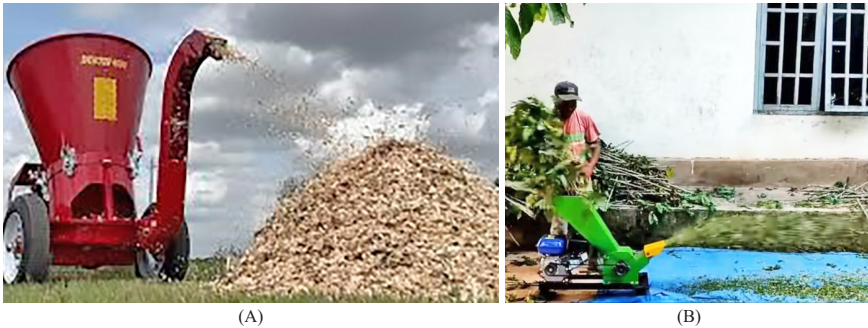
Gambar 3. Mesin pencacah kayu ( wood chipper ). Produksi luar negeri (A), produksi lokal (B)
