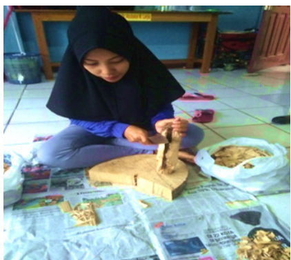
Gambar 2. Proses Pemotongan bahan baku berupa bongkahan kayu gaharu menjadi chips (sumber: Aryati (2019))
