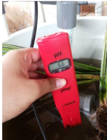
Gambar 8. Pengukuran Kadar pH
