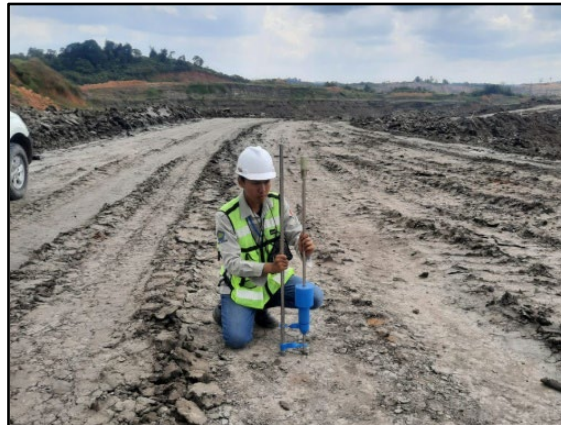
Gambar 1. Pengambilan Data Nilai Uji DCP Pada Lokasi Penelitian
