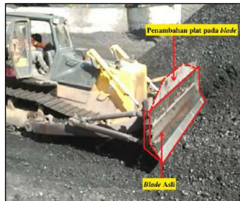
Gambar 30. Penambahan Plat Tambahan pada Blade Dozer D85E-SS Kapasitas Produksi Dozer (Dozing)
