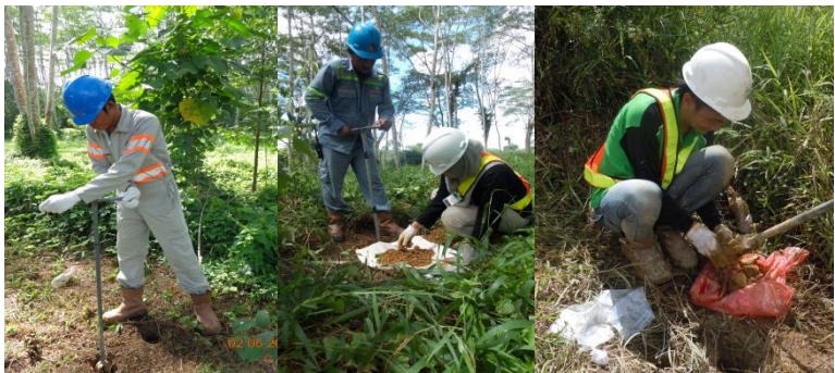
Gambar 2.2 Pengambilan Sampel Menggunakan Bor Tanah (Hand Auger) pada Kedalaman 0 - 10 cm, >10 - 30 cm, dan >30 - 60 c
