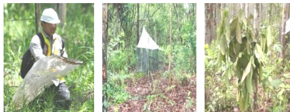
Gambar 2.16 Beberapa Teknik yang Digunakan dalam Inventarisasi Jenis Kumbang Berantena Panjang dan Kupu-Kupu: Netsweeping , Malaise Trap dan Artocarpus Trap
