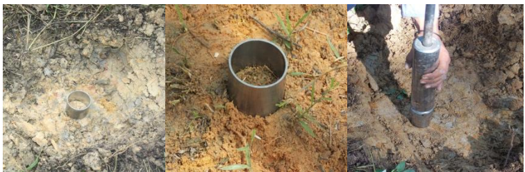
Gambar 2.3 Pengamatan Sampel Tanah Utuh Menggunakan Ring Sampler pada Kedalaman 0 - 30 cm dan >30 - 60 cm
