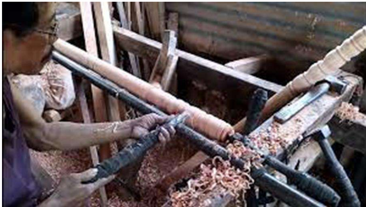
Cara kerja Mesin bubut kayu dengan pedal kaki
