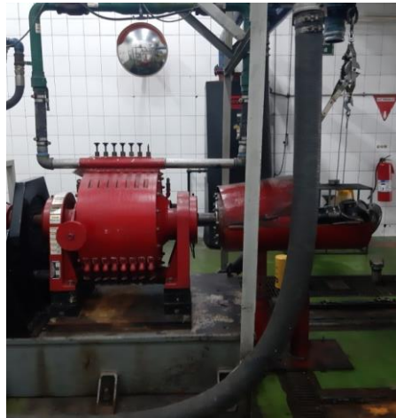
Gambar 2. Taylor dynamometer dan drive shaft Sumber : PT. Trakindo Utama Samarinda (2021)
