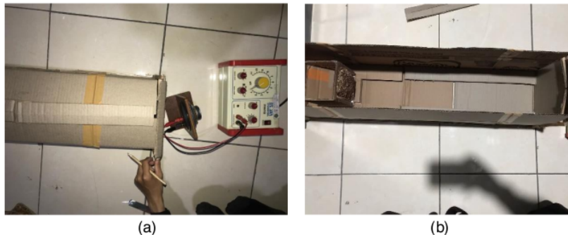
Gambar 1. Desain alat untuk mengukur efektivitas reduksi kebisingan material akustik dari kulit singkong. (a) bagian tertutup, dan (b) bagian terbuka.
