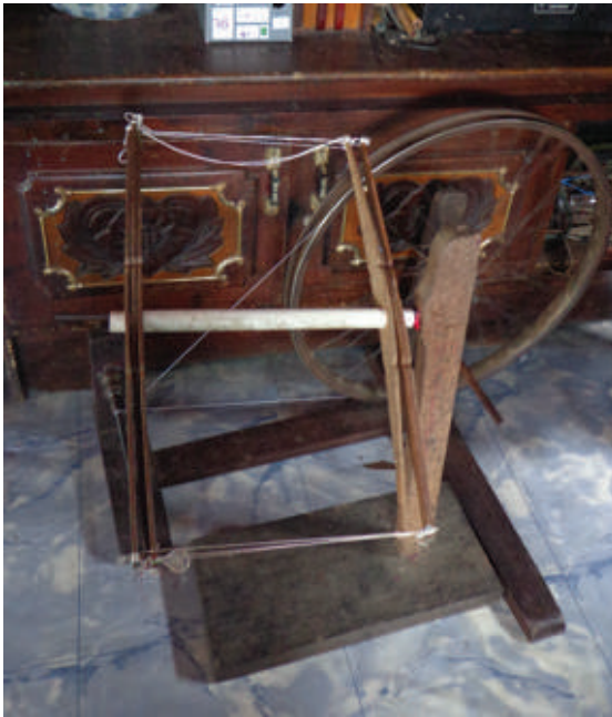
Gambar 5.2 Alat Tenun Bukan Mesin (ATBM) dan peralatan penunjang lainnya yang digunakan oleh penenun Sarung Tradisional Samarinda
