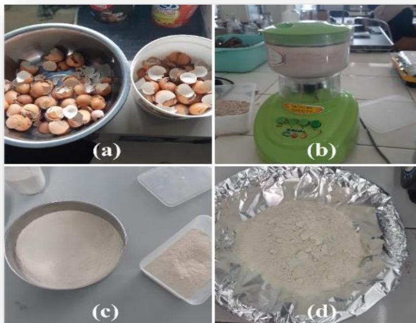
**Gambar 1** Proses Pembuatan Tepung Cangkang Telur sebagai Penjernih Air
