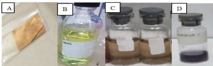
Figure 1: (A) Au foil, (B) HAuCl 4 solution, (C) the encapsulated AuNP-PAMAM G4 dendrimer, (D) the unencapsulated AuNP-PAMAM G4 dendrimer
