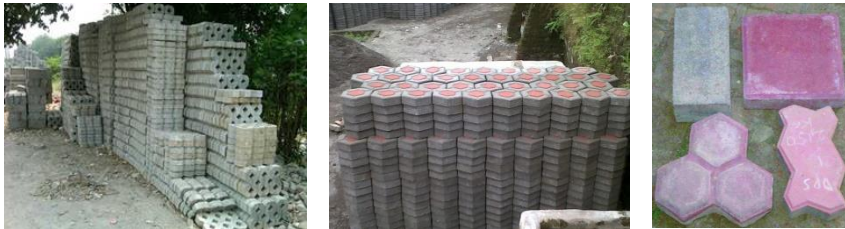
Gambar 2.1. Paving Block yang Menggunakan Lumpur Sidoarjo (Dinas PUPR Kulun Progo, 2020)
