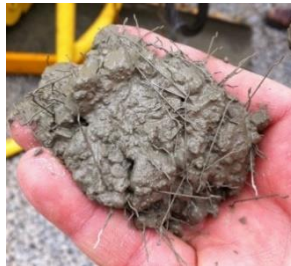
Gambar 5.6. Bentuk Campuran Beton Serat (“Apa itu Beton Fiber? - Beton Instan Indokon & Mortar Indokon,” 2021)
