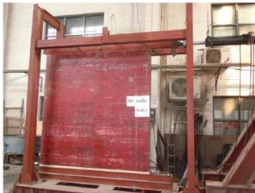
Gambar 7.1. Set Up Pengujian Dinding Geser dari Kayu
