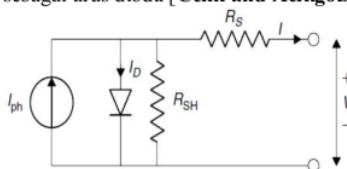
Gambar 2 Model sel PV satu diode
