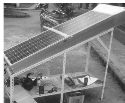
Gambar 3 Skema pengujian modul PV (100 W<sub>P</sub>)
