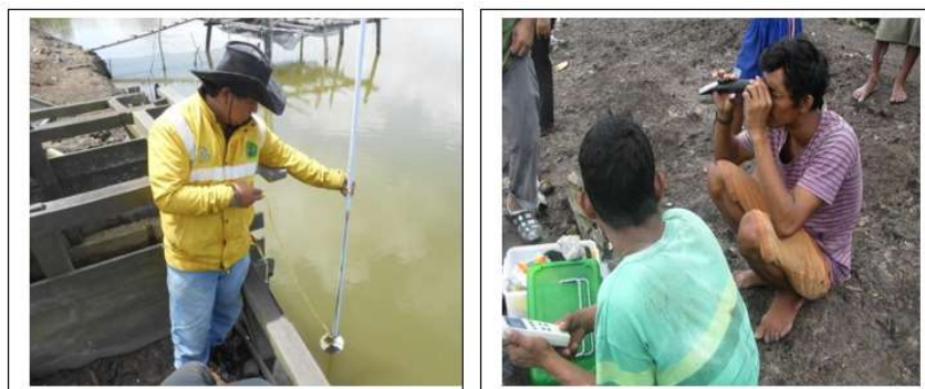
Gambar 41. Pengukuran tingkat kecerahan (kiri) dan kadar garam atau salinitas (kanan)
