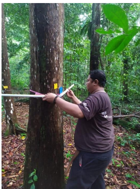
Gambar 3. Penggunaan Alat Ukur Sederhana untuk Mengukur Diameter Pohon
