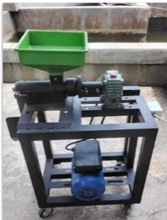
**Gambar 3.** Mesin Pencetak Pelet
