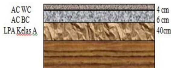
**Gambar 3.** Desain Lapis Perkerasan Lentur Jalan Akses Rancakalong
