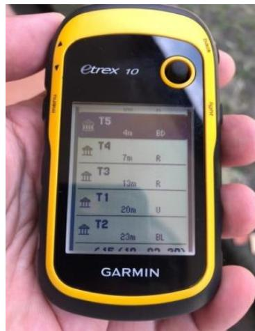
**Gambar 35. Tampilan kelola titik kecepatan Garmin seri eTrex 10**
