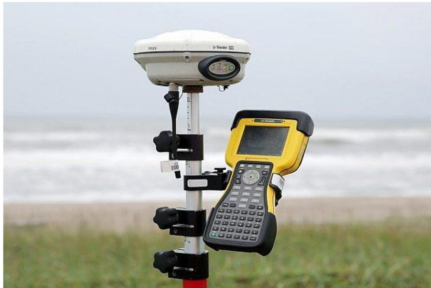
**Gambar 16. GPS geodetik**
