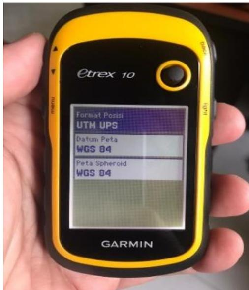
**Gambar 32. Tampilan setting datum dan sistem koordinat pada Garmin seri eTrex 10**
