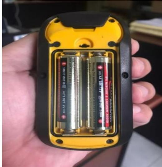
**Gambar 28. Penampakan tempat baterai Garmin seri eTrex 10**
