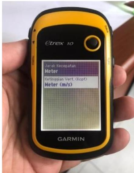
**Gambar 33. Tampilan setting satuan jarak dan kecepatan pada Garmin seri eTrex 10**
