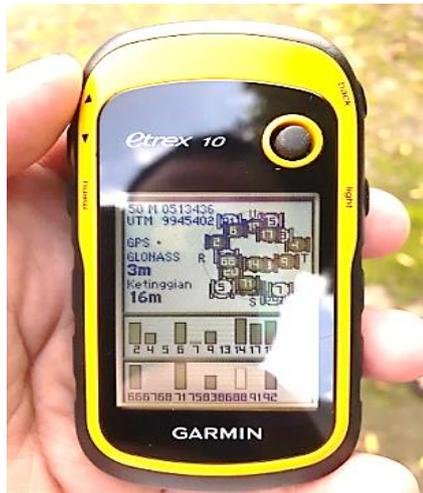
**Gambar 29. Tampilan pengaturan satelit pada Garmin seri eTrex 10**
