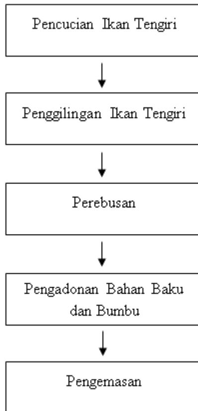
Gambar 17. Alur Proses Pembuatan Pempek Ikan Tengiri
