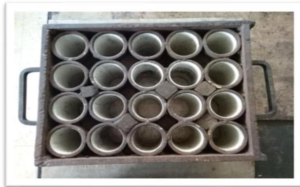
**Gambar 2.** Bentuk Cetakan Briket Arang
