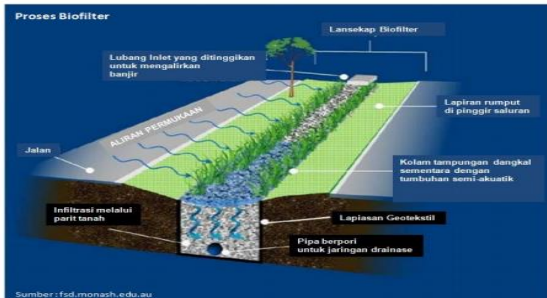
Gambar 3.15. Proses Kerja Biofilter Pada Saluran Pembuangan Air Limbah Untuk Pengelolaan Jalan Banjir
