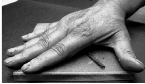
Gambar 3. 7 Penggulungan Massa Tanah Pada Pelat Kaca Tanah untuk Menentukan Batas Plastis (Cr. Braja M. Das, Henderson, Nevada)
