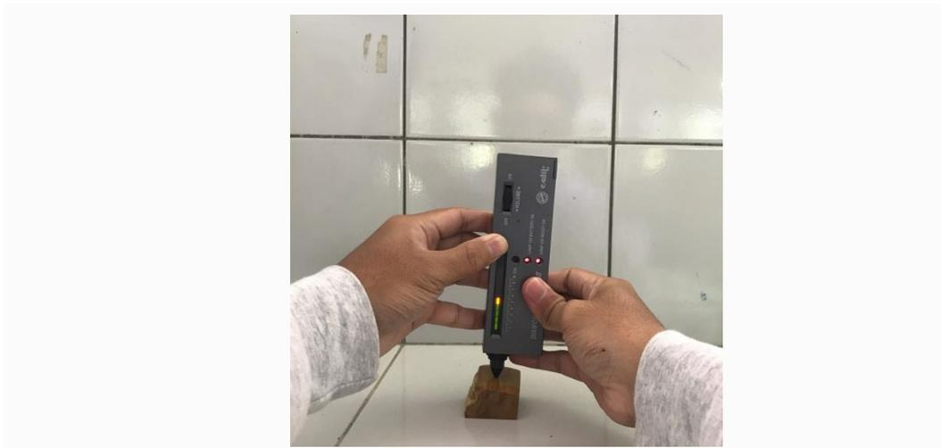
Gambar 4.6. Pengukuran Nilai Kekerasan Fosil Kayu Dengan Alat Diamond Selector
