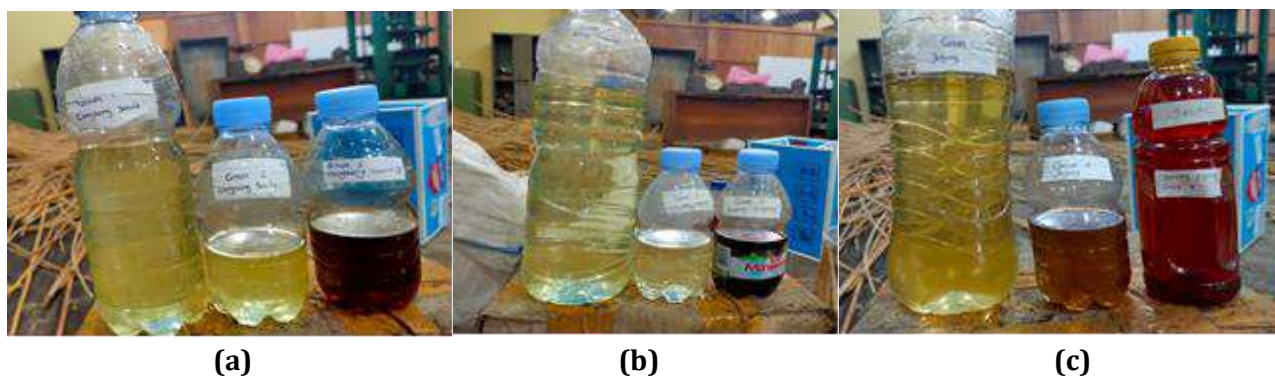
Gambar 3. (a) Warna Asap Cair Cangkang Sawit Grade 3, 2 dan 1 ; (b) Warna Asap Cair Batang Singkong Grade 3,2 dan 1 ; (c) Warna Asap Cair Batang Jagung Grade 3, 2, dan 1
